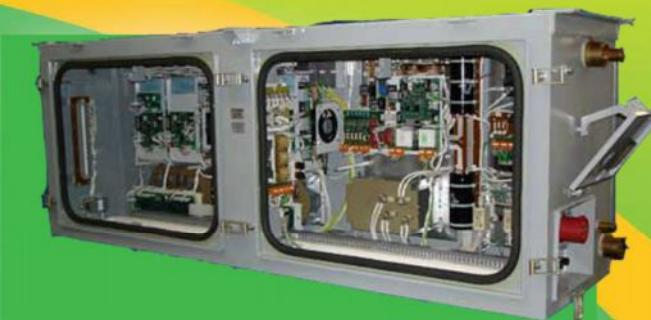
Использование высокочастотного инвертора с гальванической развязкой для заряда АБ и питания системы кондиционирования при питании от промышленной сети 380 В, 50 Гц позволило существенно улучшить технические и массо-габаритные показатели системы электроснабжения пассажирских вагонов.
